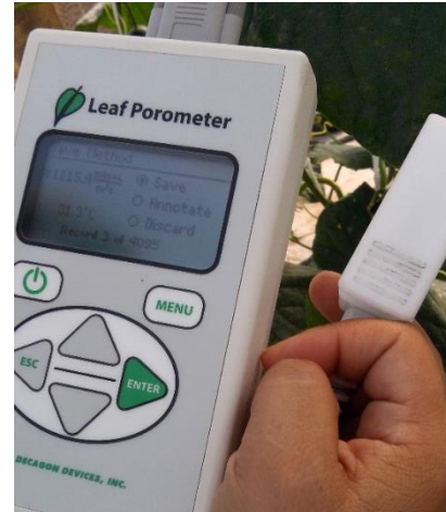
Medición de conductancia estomática mediante un porómetro modelo SC-1.
