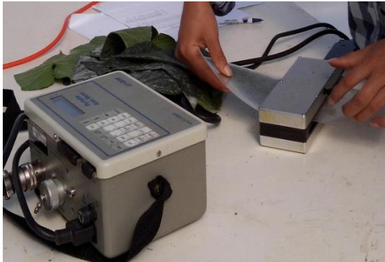
Medición del área foliar con un aparato llamado LI-COR modelo LI-3000A.
