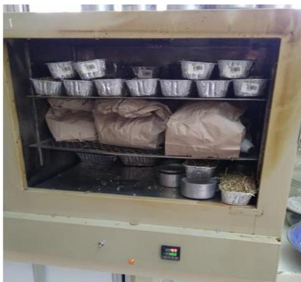
Figura 17. Colocación de las muestras en la estufa a 72 °C durante 24 horas para el secado de las muestras.
