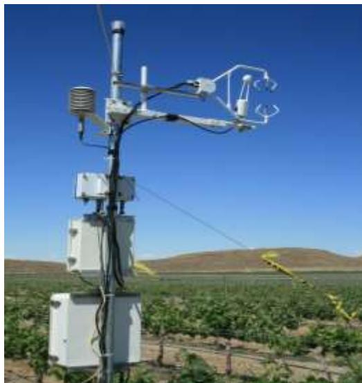
**Figura 1.** Sensores de un sistema Eddy sobre una plantación de vid (cv. Shiraz) para medir el intercambio neto de bióxido de carbono (NEE) entre el dosel del viñedo y la atmósfera.
