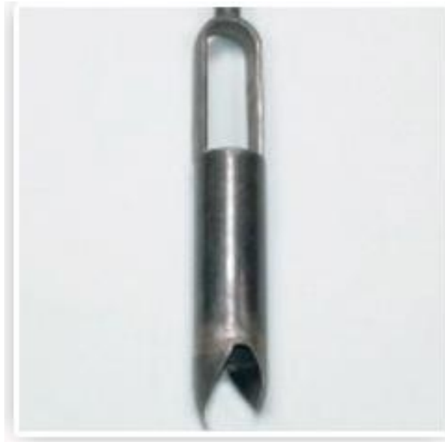
Figura 3. Imagen que muestra el tipo de barrena utilizada para la obtención de las muestras de suelo.
