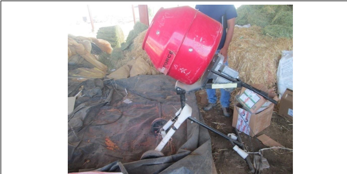
Figura 7. Máquina revoladora utilizada para facilitar el mezclado de la semilla de maíz forrajero y tanto el producto Semevin como el Acadian suelo.
