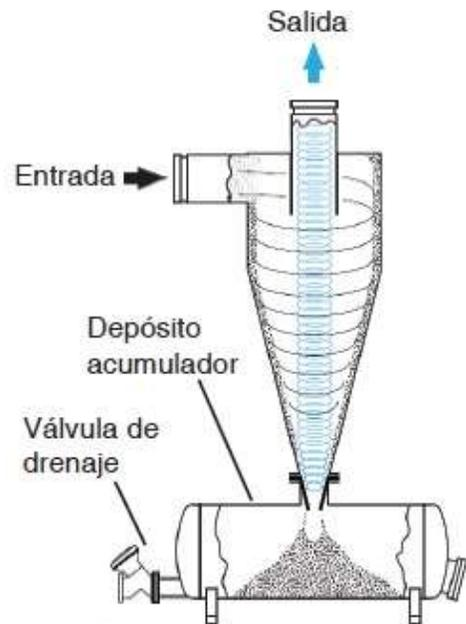
**Figura 2. 2** Filtro tipo Hidrociclón **Figura 2. 3** Esquema de trabajo del Hidrociclón
