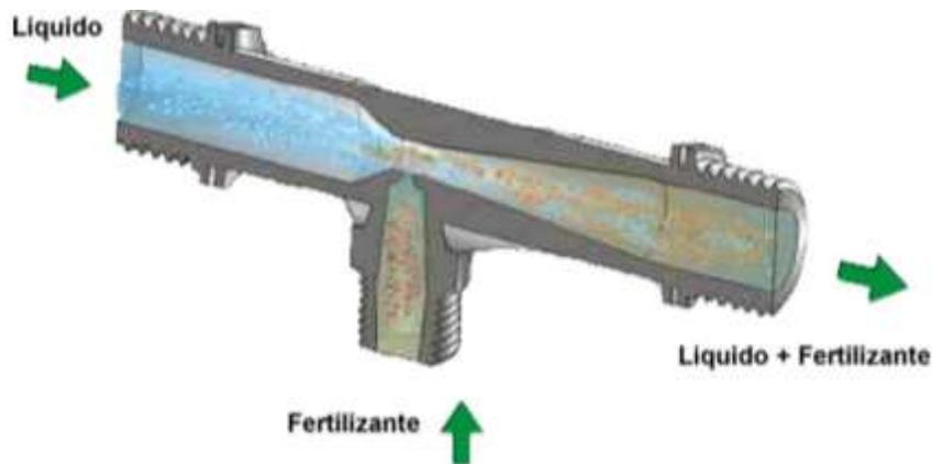
**Figura 2. 12** Inyector Venturi, representación del movimiento de los fluidos, dentro del filtro.
