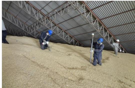
*Aplicación de fosforo de aluminio con sondas (inyectores).*
