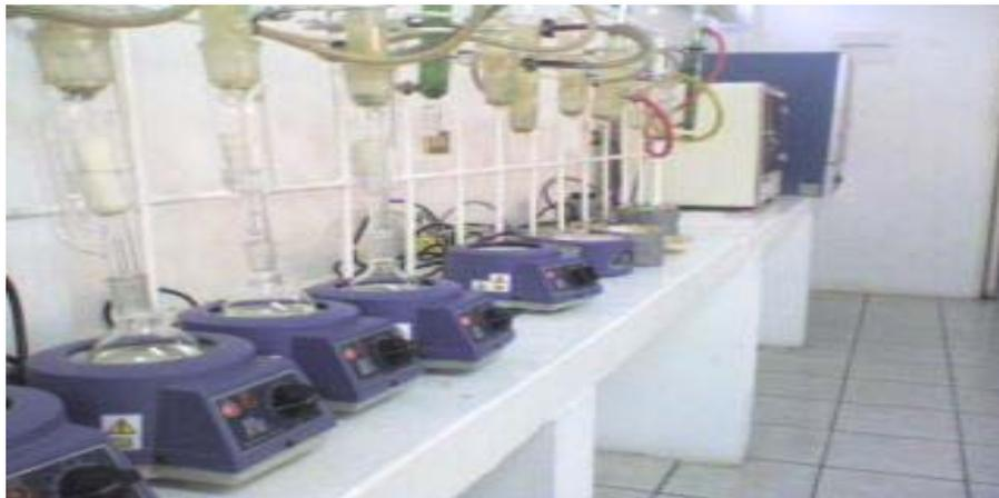
Figura 1. Método Soxhlet Extracción de Grasa
