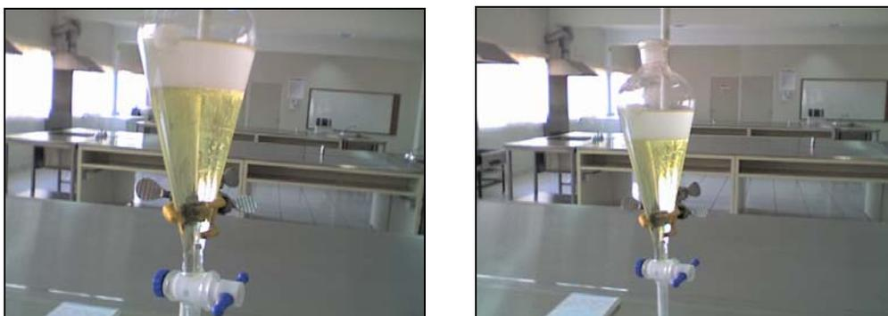
**Figura A.** Extracción del antioxidante Terbutil hidroxi-quinona (TBHQ)
