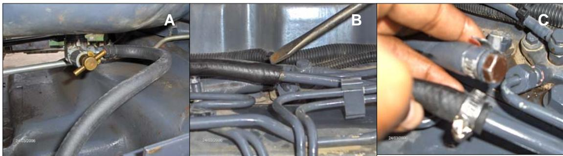
Figura 3.6 Válvula de paso del tanque de combustible (A); localizar la manguera del retorno (B); conexión de la manguera del retorno (C).
