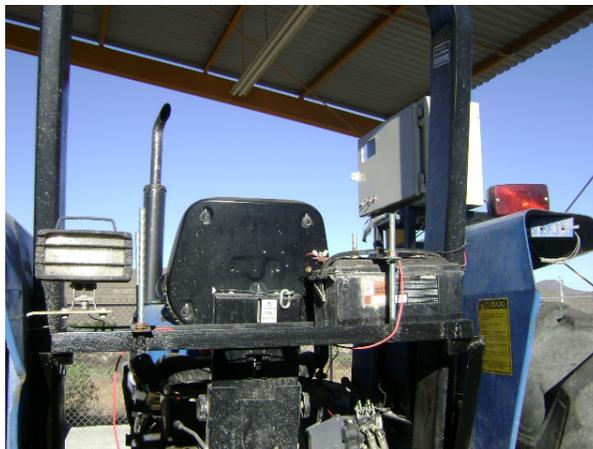
Figura 3.19 Soporte para la batería
