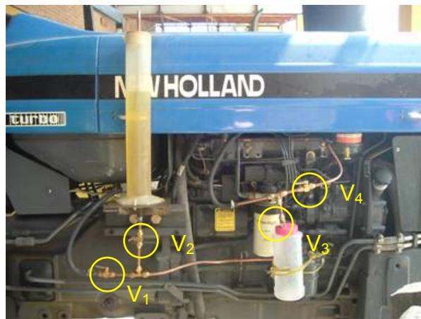
Figura 4.2 Medidor Manual de Combustible Propuesto
