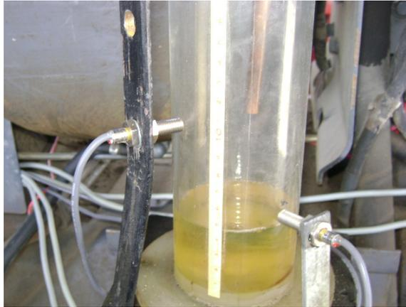
Figura 3.17 Sensores fotoeléctricos detectando el diesel del depósito
