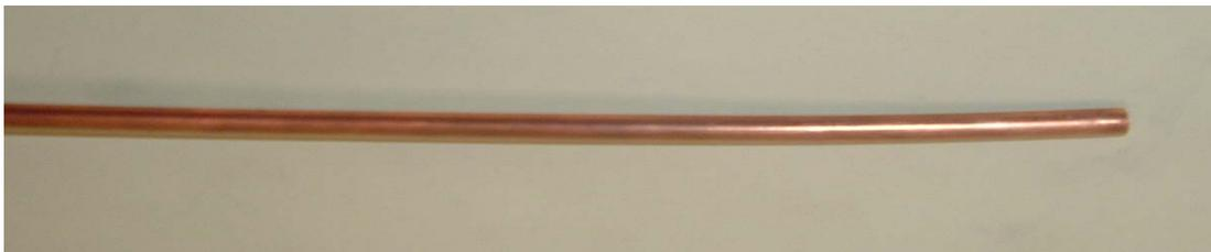
Figura 3.4 Tubo de cobre de 5/16"
