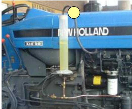
Figura A2.2 Diseño con un filtro y tubo alargado en la manguera del Retorno
