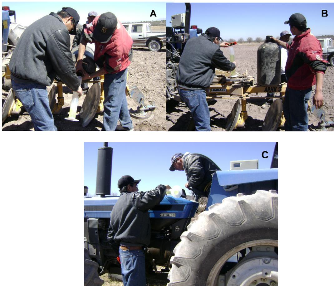
Figura 3.24 La probeta se llena con diesel (A); verificando el volumen de la probeta (B); la probeta llena al tanque de combustible (C)
