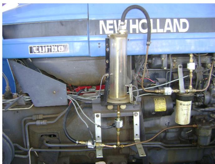
Figura 4.5 Cableado de los sensores y las electroválvulas
