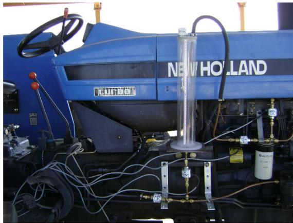
Figura 3.15 Depósito de Combustible y Estructura de Cobre Terminadas
