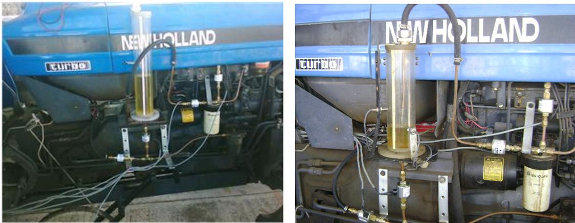
Figura A4.1 Verificación del flujo de diesel del retorno (I); Depósito con una altura menor (26 cm) (II).
