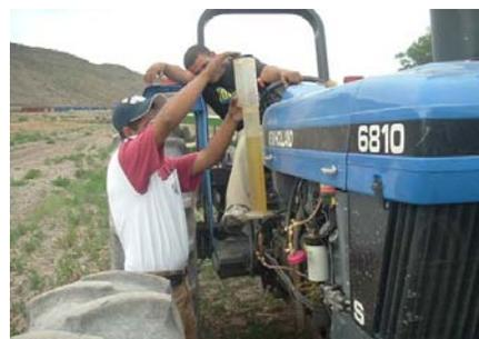
Figura 3.22 Llenado de la probeta con el diesel que contiene el recipiente del retorno
