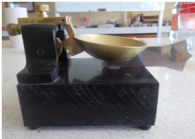
Figura 2. Calibración del aparato (Copa de Casagrande) para determinar el límite plástico.
