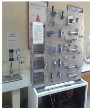
Figura 8. Banco neumático aplicador de presión a través de un compresor.
