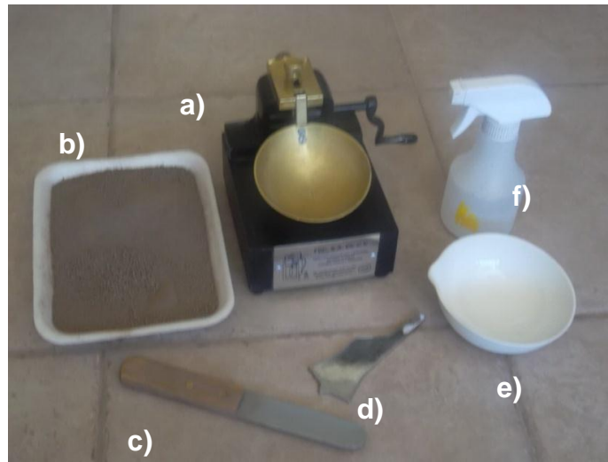
Figura 1. Materiales para determinar el límite líquido. a) copa de Casagrande, b) suelo tamizado a 0.5 mm, c) espátula, d) herramienta de ranurado, e) cápsula de porcelana, f) agua destilada.
