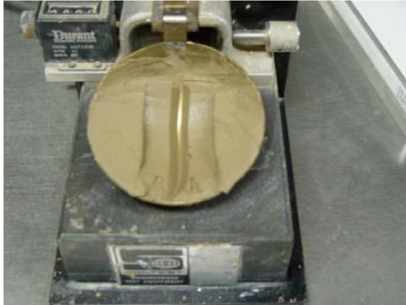
Figura 3. Realización de la ranura en la pasta de suelo con la herramienta estándar de corte.
