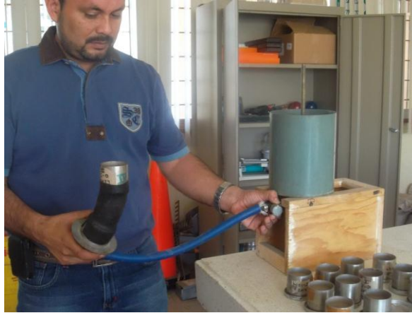
Figura 15. Prueba de permeabilidad utilizando el PERMEAMETRO KMOCH.
