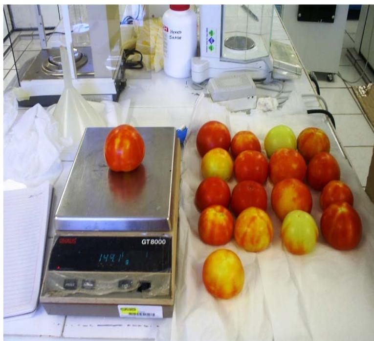
Figura 7. Balanza digital para pesado de muestras.
