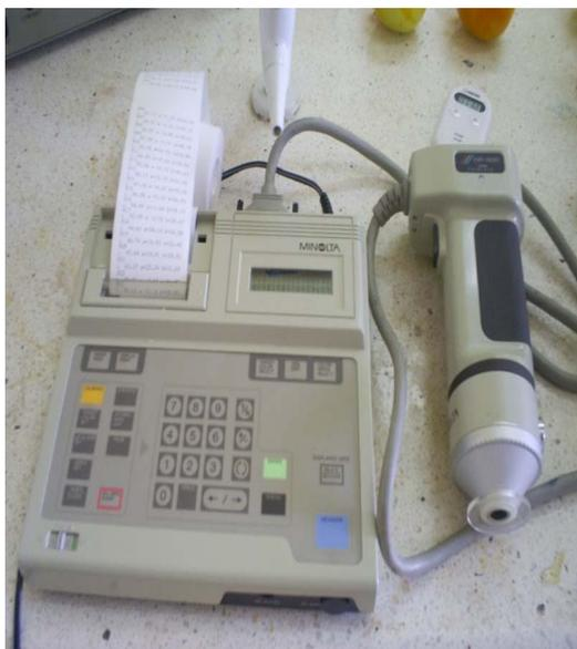
Figura 8. Colorímetro Minolta CR-300.
