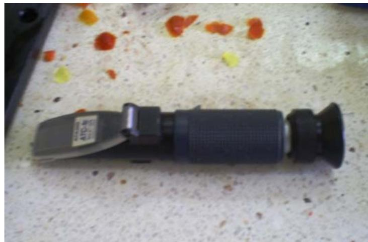
Figura 11. Refractómetro
