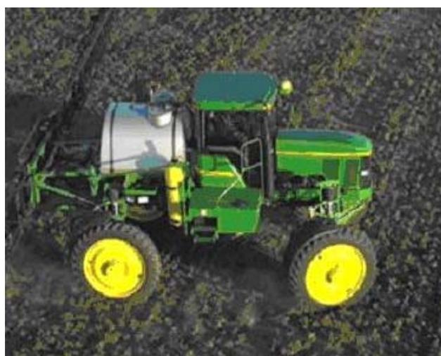
Figura 2.2. Aspersora motorizada de bajo volumen (TeeJet, 1998).
