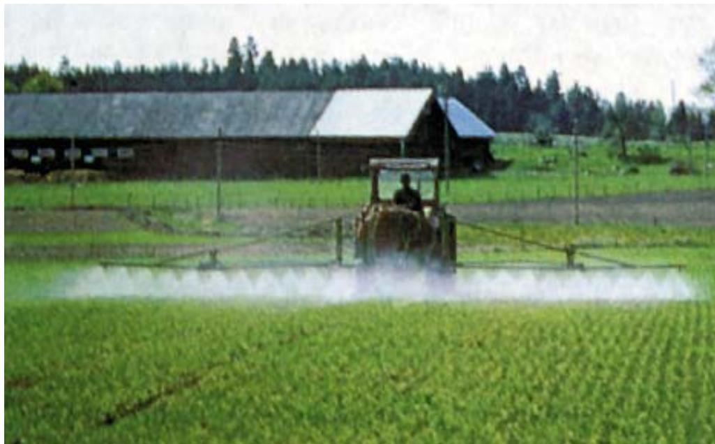
Figura 2.3. Aspersora motorizada universal (TeeJet 1998).
