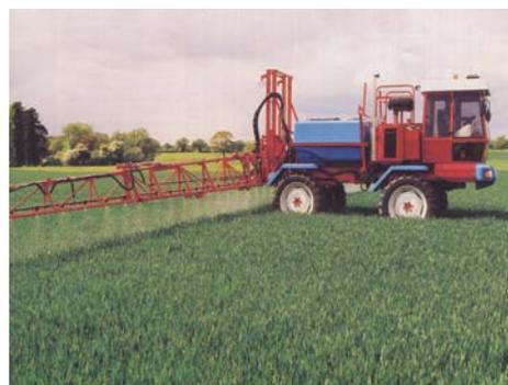
Figura 2.1. Aspersora motorizada de alto volumen (TeeJet, 1998).
