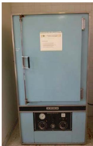
Figura 5. Estufa de secado BLUE M Electri Compani (BLUE ISLAND, ILLINOUS U.S.A.)
