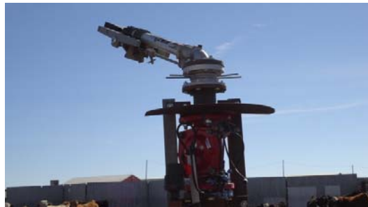
Aspersor de agua para disminuir la temp. del ganado
