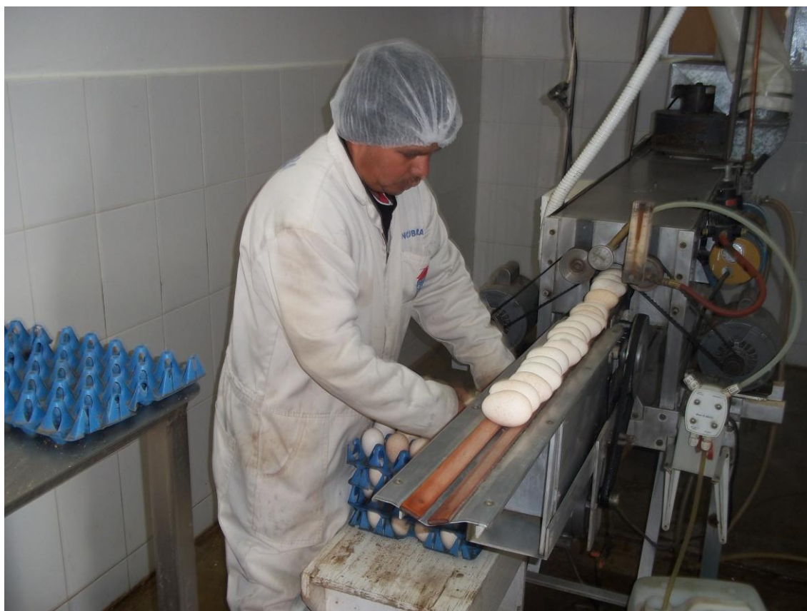
Figura 8: Operador colocando el huevo incubable en la maquina lavadora para ser lavado y desinfectado.
