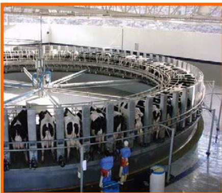
En el área ganadera posee una sala de ordeño tipo rotativa marca DeLaval de 80 plazas con identificación y pesadores automáticos. Esta sala se encuentra totalmente automatizada y cuenta con puertas de corte automático para seleccionar animales, además de estar 100% integrada a los sistemas computacionales para evitar duplicidad de trabajo y funciones. Entre otras características cuenta con frío instantáneo para el enfriamiento de la leche,
