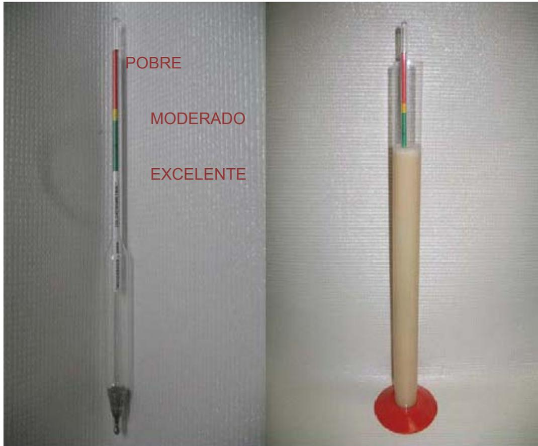
Figura 1. Calostrómetro utilizado para medir la concentración de inmunoglobulinas en el calostro.
