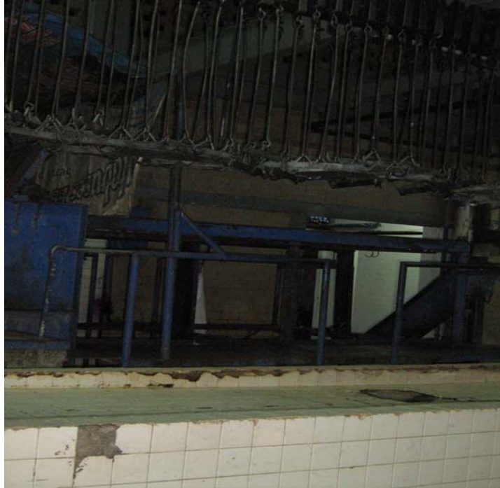
IMAGEN 3.- Se observa el mal estado de la plancha para el lavado de vísceras.
