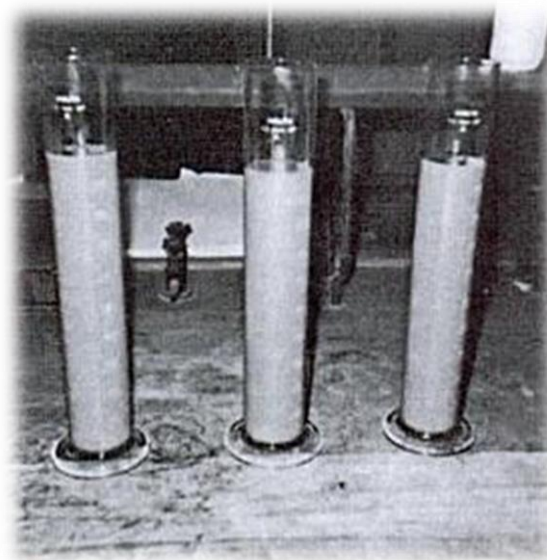
Figura 12.- Determinación de la textura por el método del densímetro de Bouyoucos.
