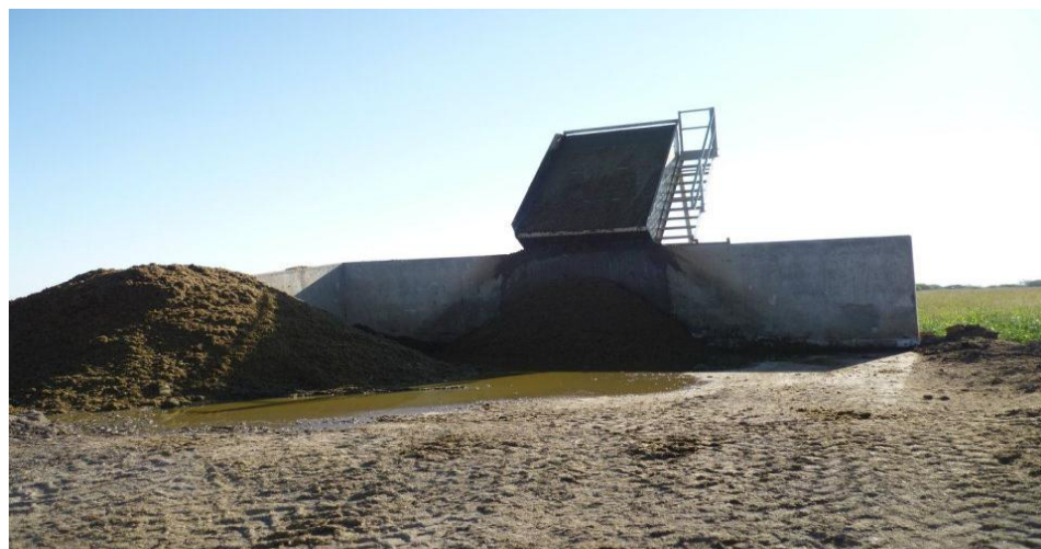
Figura 1. Separador de sólidos del establo Rancho el Porvenir
