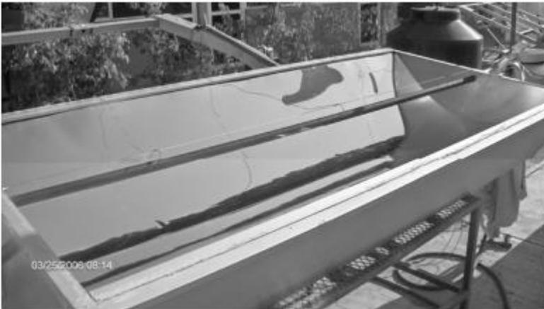
Figura 1.8. El colector concentrador de canal parabólico.
