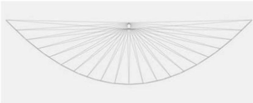
Figura 1.10. Diagrama de trazado de rayos y diámetro mínimo requerido de tubería. Con base en las dimensiones y la geometría de la parábola, el diámetro teórico del receptor del CCP es (Beckman y Duffie, 1991).
