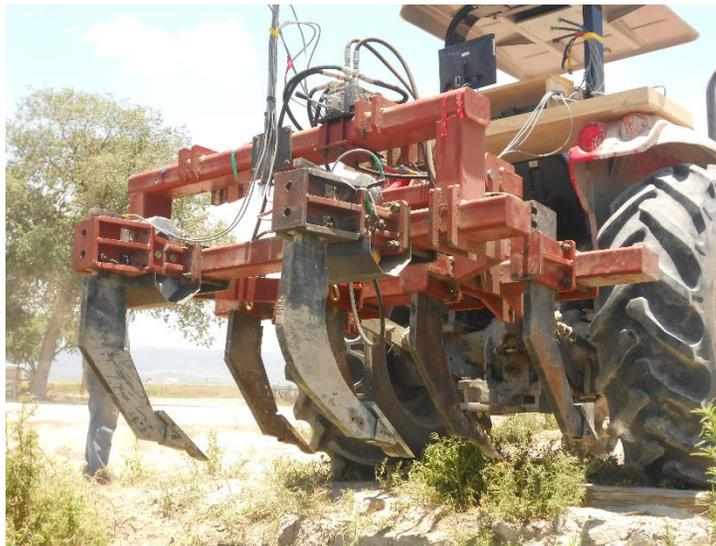
**Fig. 4.4** Prototipo de labranza inteligente con válvula electrohidráulica.
