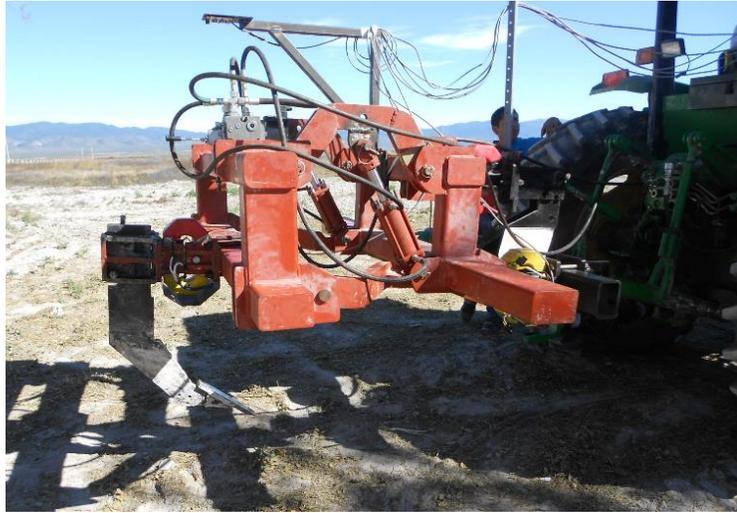
**Fig. 4.5 Prototipo de labranza inteligente para la medición de pulsos arrojados y distancia recorrida por los actuadores hidráulicos.**
