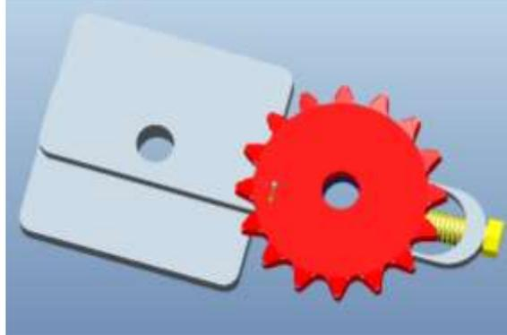
**Figura 4.21** Tensor con ajuste de tornillo.
