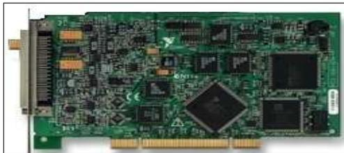
Figura 3.11.- Tarjeta de adquisición de datos PCI-NI-6221.
