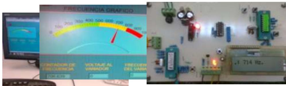
Figura 4.11.- Frecuencia en la pantalla de cristal e Instrumento virtual.
