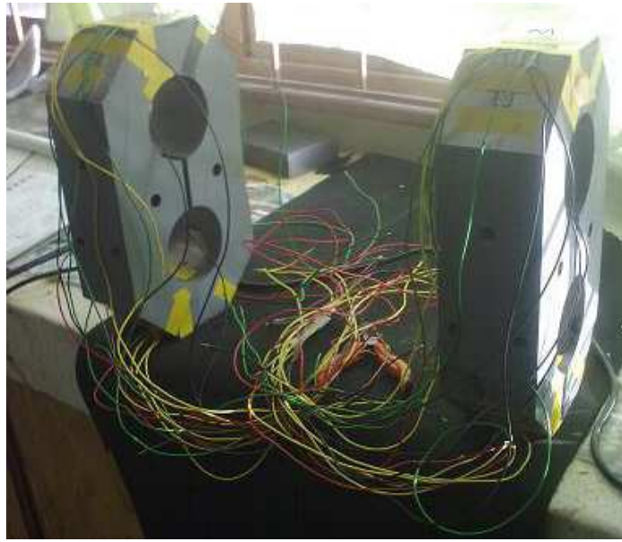
Figura B5. Cableado de Sensores Octagonales.
