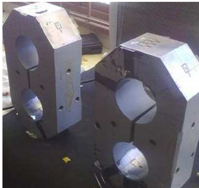
Figura B3: Galgas Extensiométricas colocadas en el sensor octagonal.
