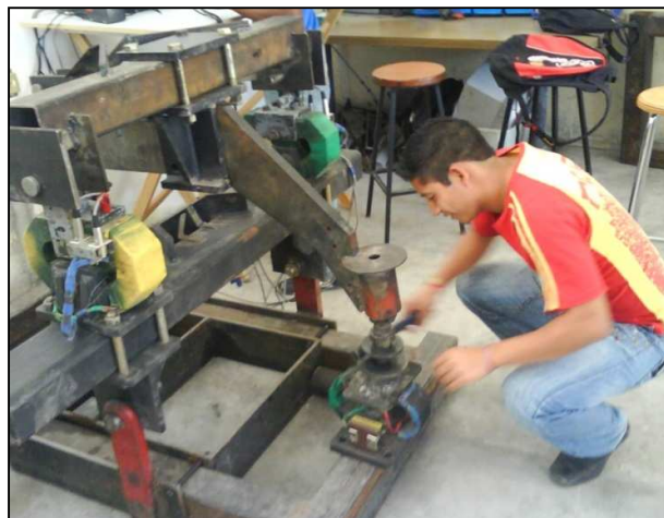
Figura 4.12. Pruebas con los sensores integrales con sus respectivas fuerzas montado en el banco de pruebas.
