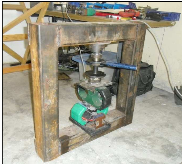
Figura 4.3. Marco de calibración de los sensores individuales con capacidad de 10 kN.
