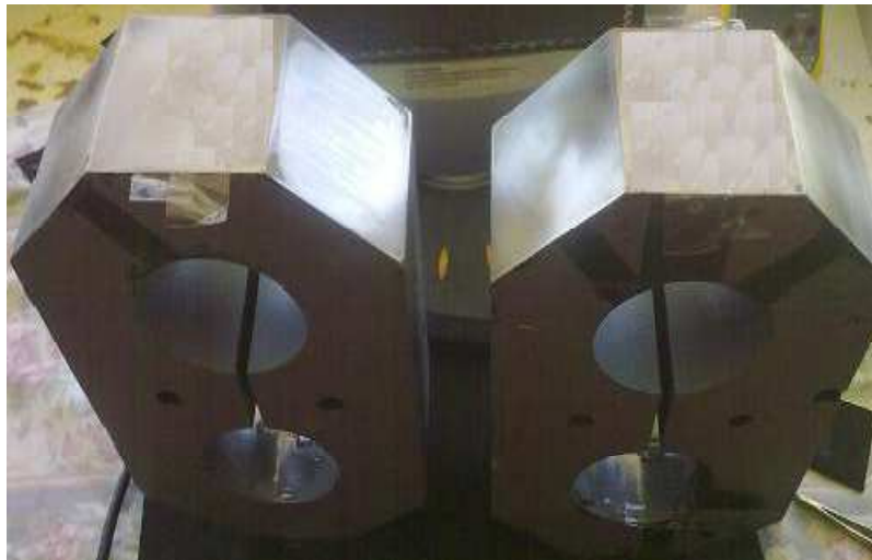
Figura B1. Octagonal lijado, listo para la colocación de las galgas.
