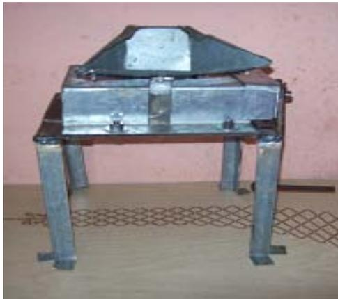
Figura 5.1 Máquina quebradora de piñón manual.
