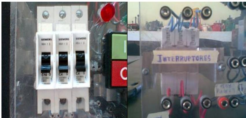
**Fig. 4.5.** Unidad de de interruptores con sus respectivos conectores
