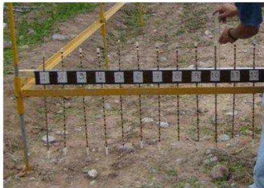
Fig. 10. Toma de lecturas (Regla) del microrrelieve por medio del perfilómetro de 2m de ancho.
