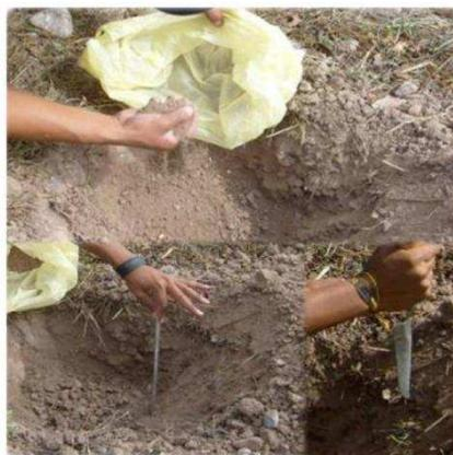
Fig. 14. Obtención de las muestras del suelo para su posterior análisis en laboratorio.
