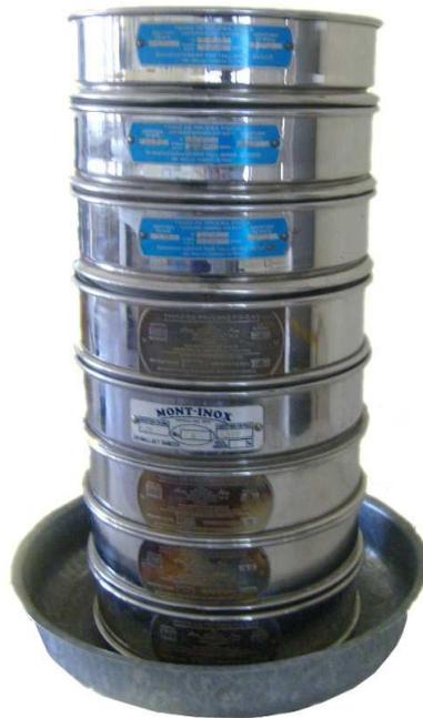
Fig. 22. Distribución de los tamices utilizados según diámetro.
