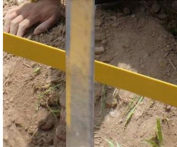
Fig. 20. Determinación de la profundidad de trabajo realizado por el cincel.
