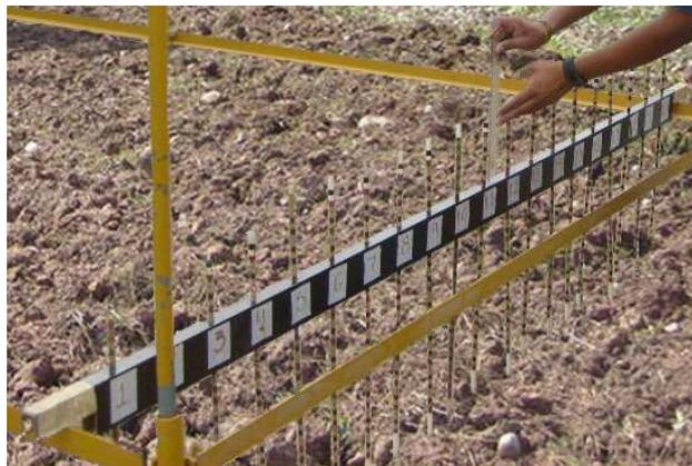
Fig. 21. Medición del microrrelieve después del paso del cincel.
