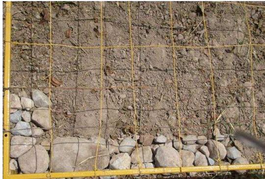
Fig. 12. Medición de la pedregosidad con el marco de solera de  $1\text{m}^2$ .
