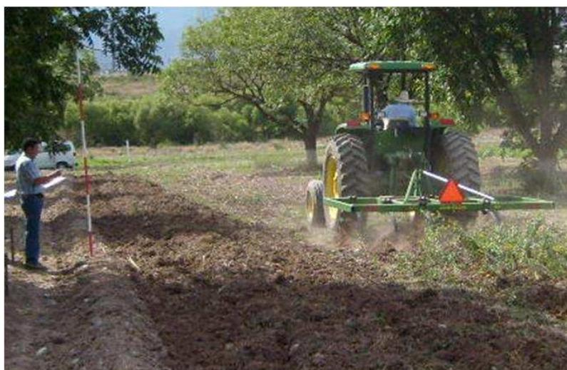
Fig. 18 Medición de la velocidad de avance.
