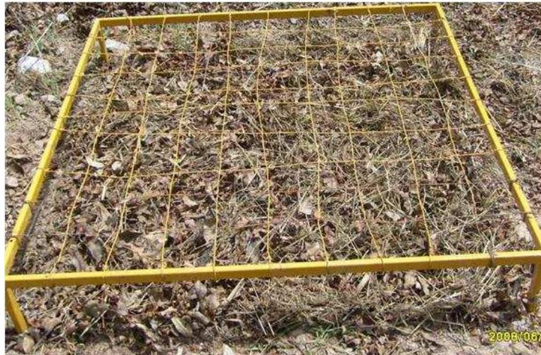
Fig. 11. Medición de la cobertura con el marco de solera de 1m<sup>2</sup>.
