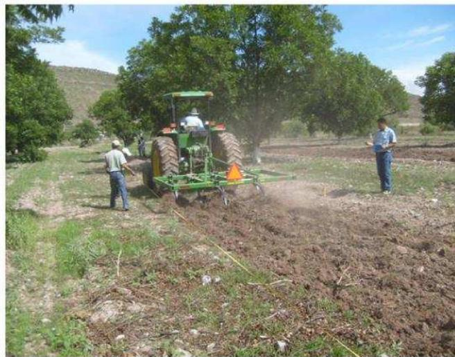
Fig. 16. Medición del patinaje en 5 revoluciones de las ruedas tractivas del tractor.
