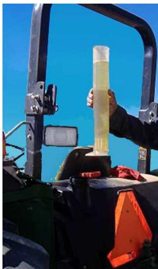
Fig. 17. Medición del combustible por el método del tanque lleno.
