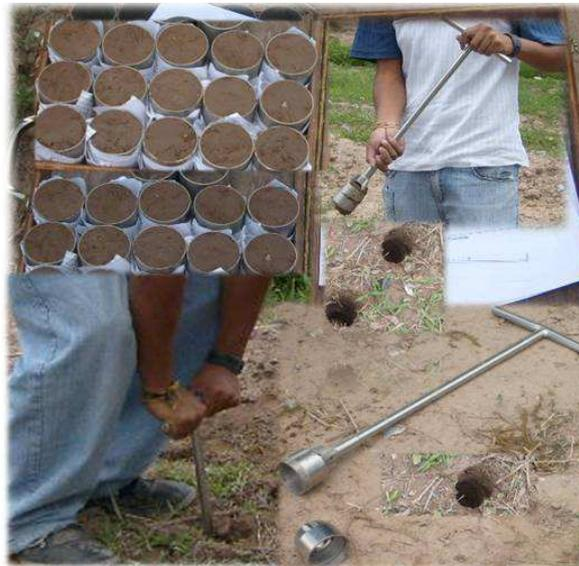
Fig. 13. Obtención de las muestras de suelo para la determinación Da.
