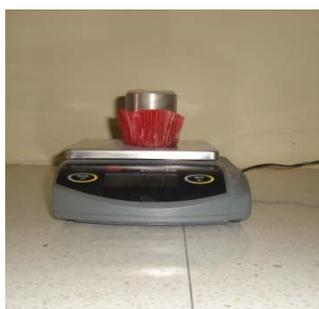
**Figura 3.4 Balanza digital con precisión de 0.1 gr.**
