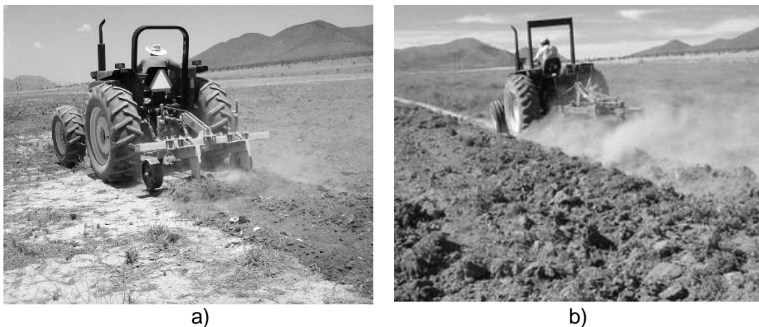
Figura 4. Acciones de labranza. a) Labranza vertical y b) convencional.
