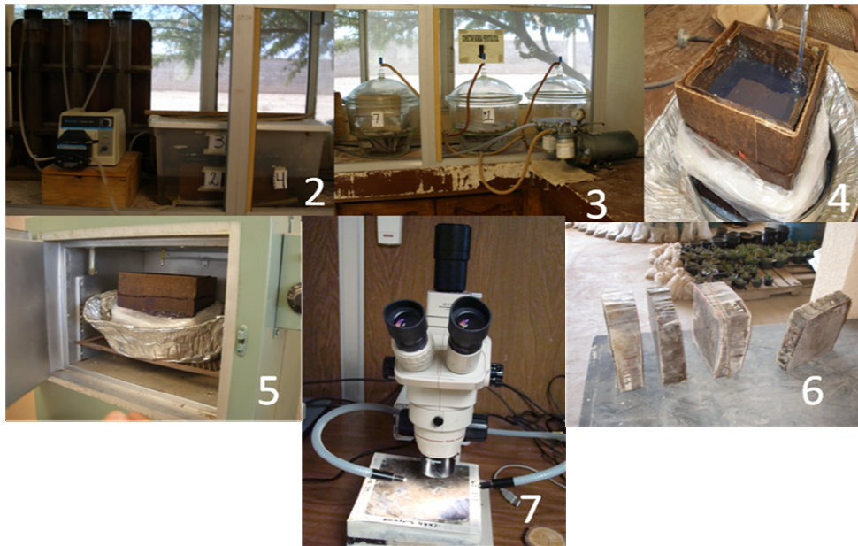
Figura 7. Ilustración de los pasos requeridos para la preparación de las muestras en el laboratorio. 2) Colocación de las muestras en una cámara de intercambio agua por acetona; 3) Colocación de las muestras en los desecadores; 4) Incorporación de la resina a la muestra; 5) Traslado a la estufa durante 24 hr; 6) Corte y pulido de muestras; 7) Sesión fotográfica.
