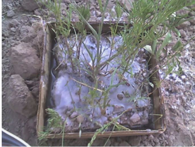
Fig. 6. Muestra inalterada para su traslado al laboratorio.
