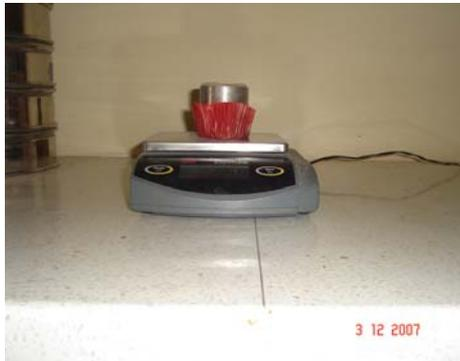
Figura 3.6 Balanza digital con precisión de 0.1 g.
