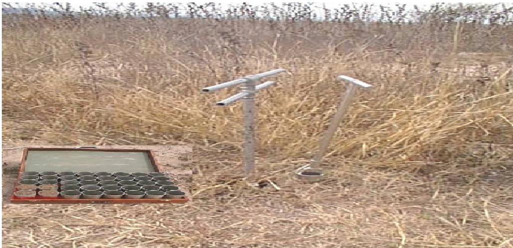
Figura. 3.2 Recolección de muestras y barrenas extractor de núcleo.
