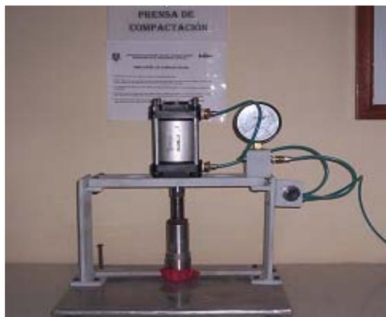
Figura 3.4 Prensa neumática.
