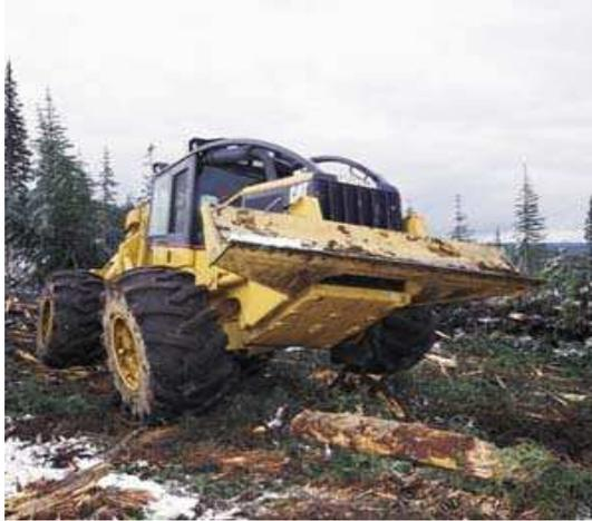
Figura 9. Saca mecanizada por arrastre. (www.asemfo.org, citada en el año 2005).
