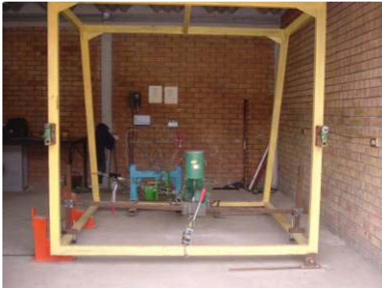
Fig. 2.16 Sembradora montada en el banco de pruebas.
