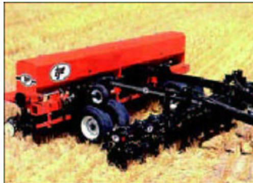
Fig. 2.15. Sembradora Massey Ferguson
