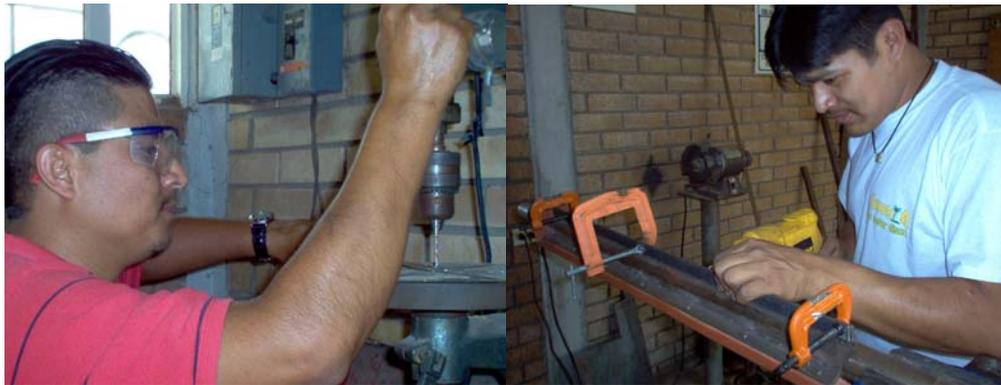
**Figura 3.2 Taladrado de solera para sujeción de empaques.**
