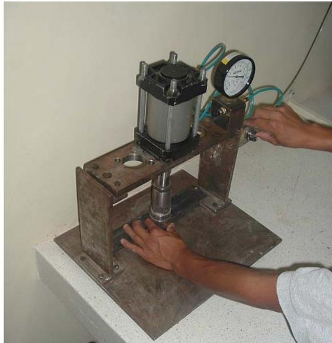
Figura 3.4 Prensa neumática (simulador de compactación)
