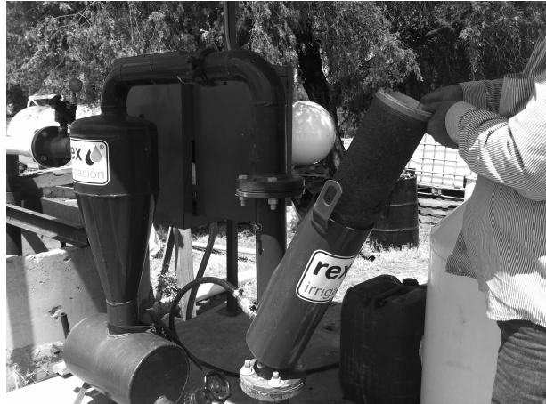
Figura 1.23. Desensamble de Elemento Filtrante de Malla.
