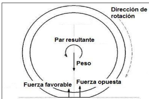
**Figura 2.5 Resistencia a la rodadura.**
