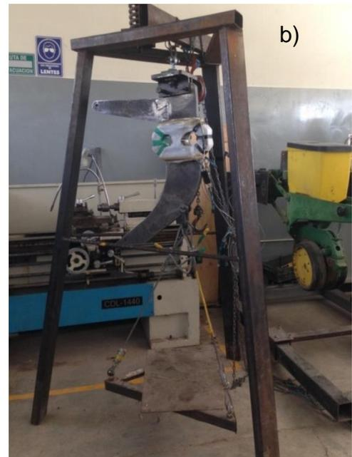
**Figura 4.1 a) posición cargas para determinar la constante en la fuerza horizontal. b) posición cargas para determinar la constante en la fuerza vertical.**
