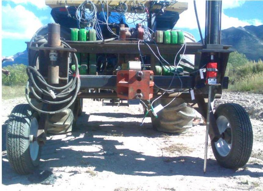
**Figura 3.6 Carro Portasensores utilizado para identificación de las capas compactadas del suelo.**
