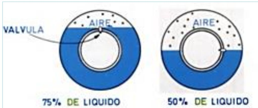
**Figura 2.4 Lastrado con agua en los neumáticos (Arnal y Laguna, 2005).**
