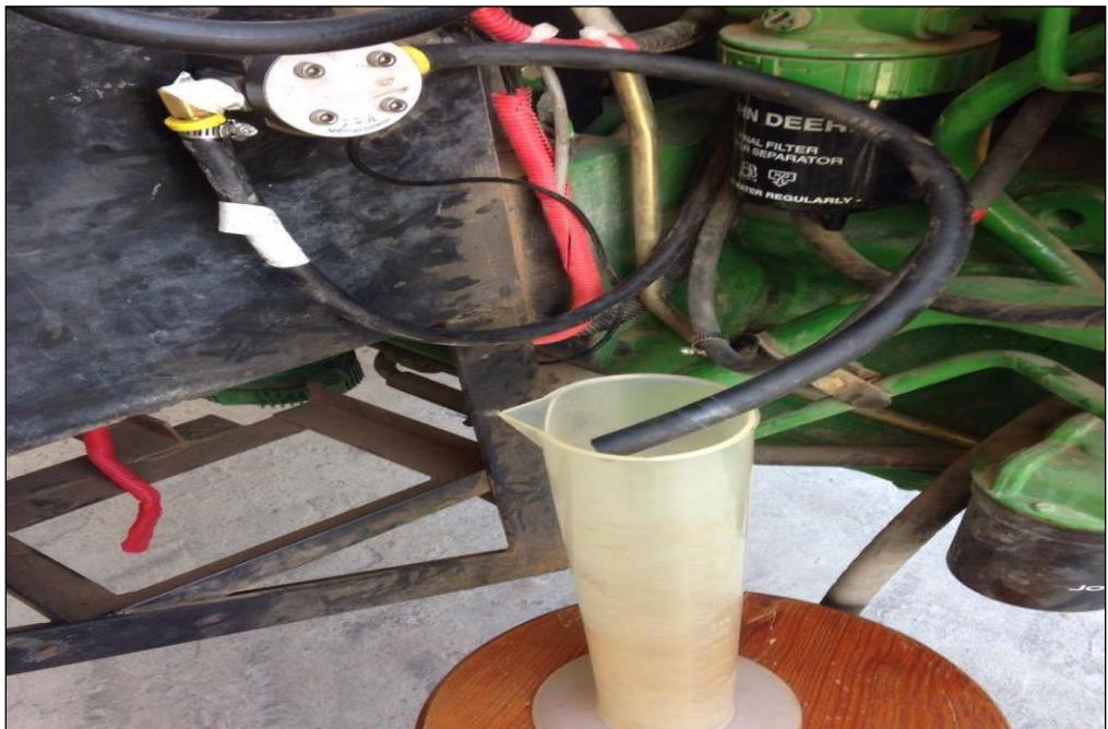
Figura 3.5 Calibración de consumo de energía.
