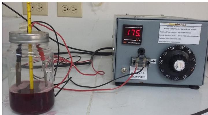
**Ilustración 6.** Celda de aplicación a nivel laboratorio utilizada para el proceso de pasteurización óhmica del jugo de granada.
