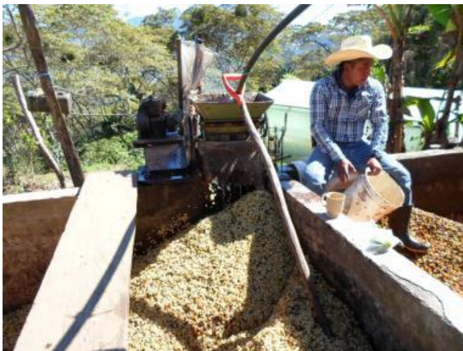
Figura 17. Expulsión de grano despulpado hacia el tanque de fermentación.
