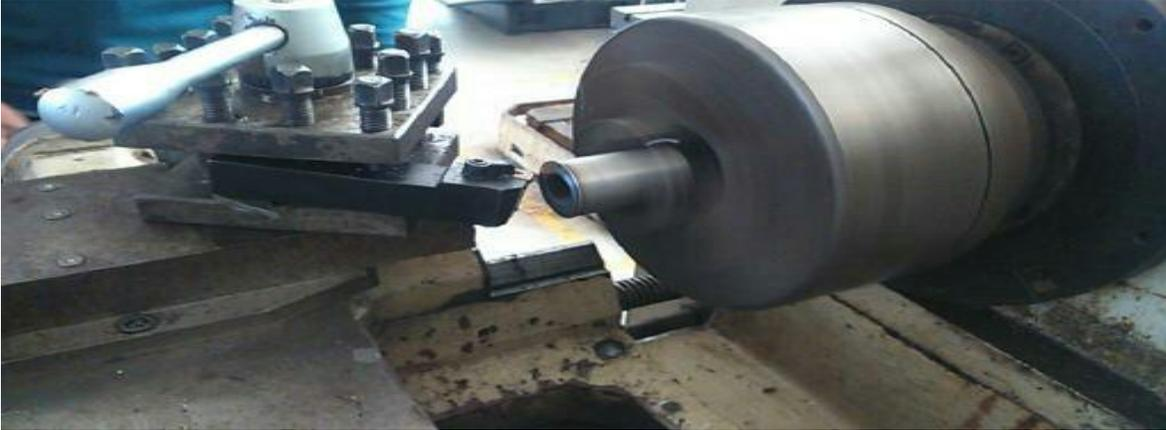
**Fig. 3.5 Maquinado de pieza para el para el acoplamiento de la flecha del motor Parker.**
