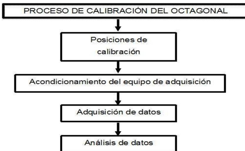
**Fig. 3.1. Diagrama del proceso de calibración del octagonal extendido.**
