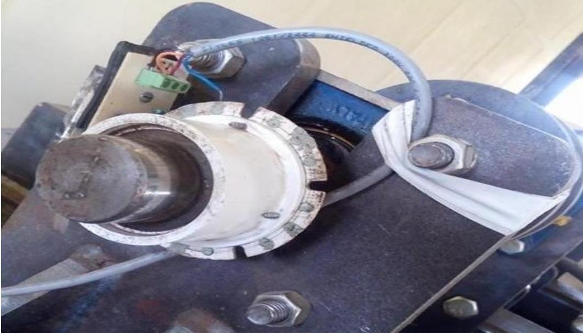
**Fig. 4. 3 Sistema para la determinación de la velocidad angular.**
