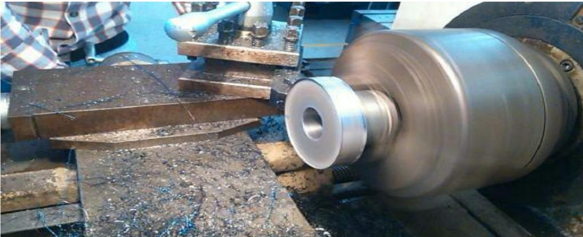
**Fig. 3.6 Maquinado de pieza para el acoplamiento del engrane de 19 dientes.**
