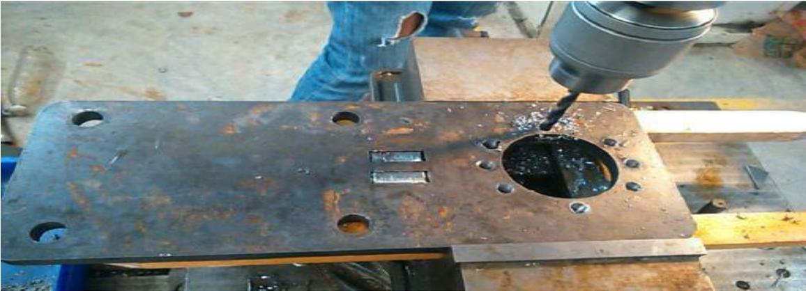
**Fig. 3.7 Barrenos para el acoplamiento de una chumacera.**
