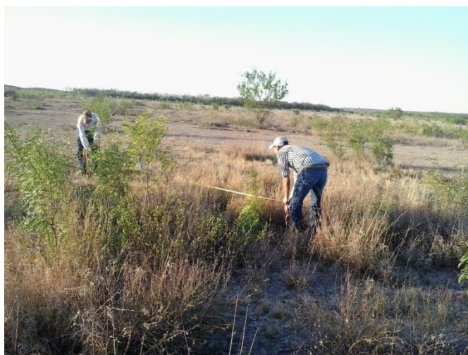
Figura 7. Método de línea de Canfield para determinar la cobertura vegetal en ambos sitios.
