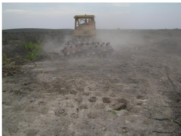
Figura 4. Paso del rodillo aereador creando cuencas o sitios de germinación.
