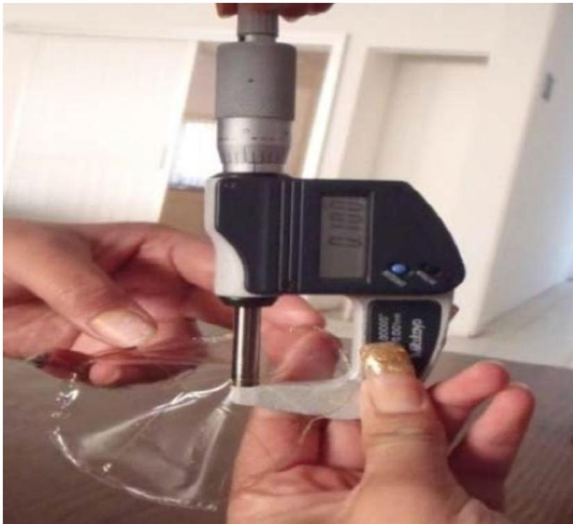
Figura 3. Micrómetro digital empleado para medir el espesor de las películas comestibles.
