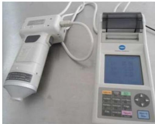
Figura 4. Colorímetro, Minolta modelo CR-400.
