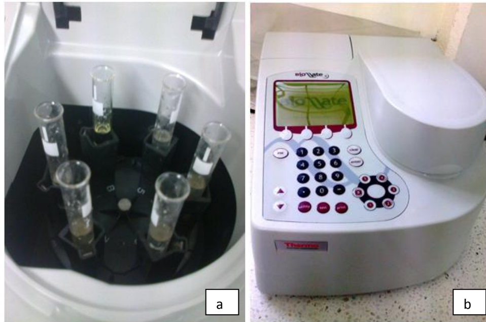
Figura 3.10 Cuantificación de auxinas de las plántulas normales de Chile habanero, a) una repetición, tratamiento por tubo y b) lectura en el espectrofotometro Serie BioMate 3.
