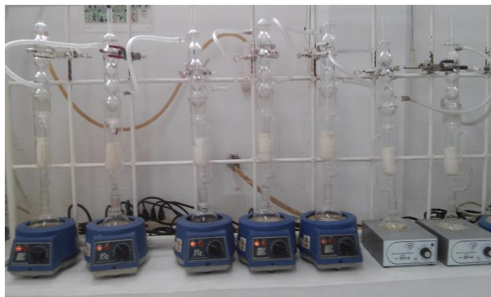
Figura 19. Imagen de equipo soxhlet determinando grasa.
