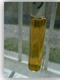
Figura 11. Tubo estéril con campanas Durham invertidas.
