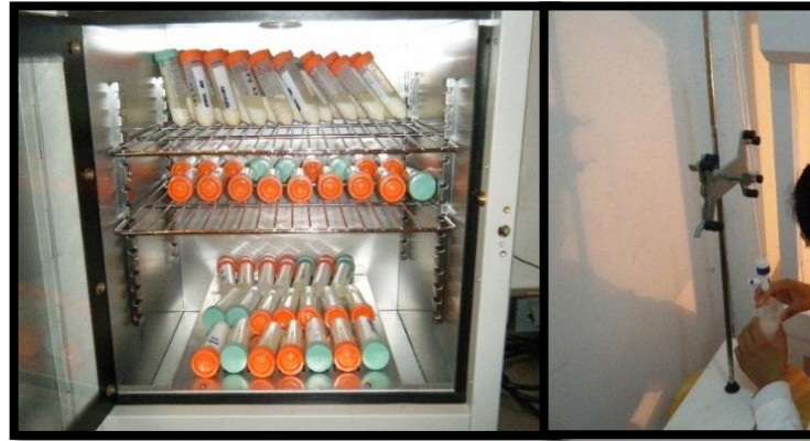
Figura 9. Incubación de la leche inoculada y titulación de cada una de las muestras a diferentes periodos de tiempo.
