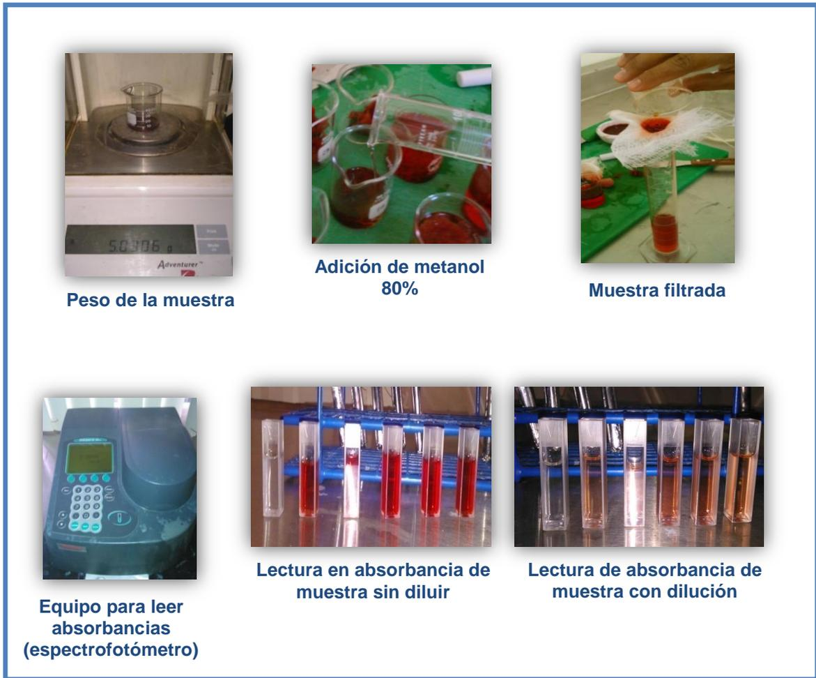
Figura. 13 Diagrama de proceso de la determinación de pigmentos
