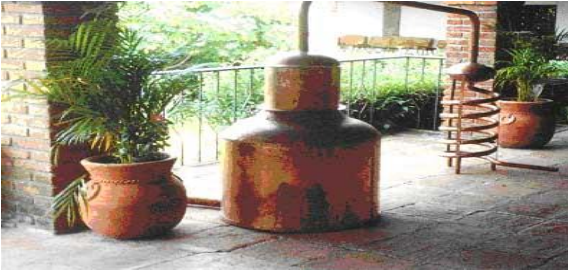
Figura 11: Campana y Serpentín del Alambique
