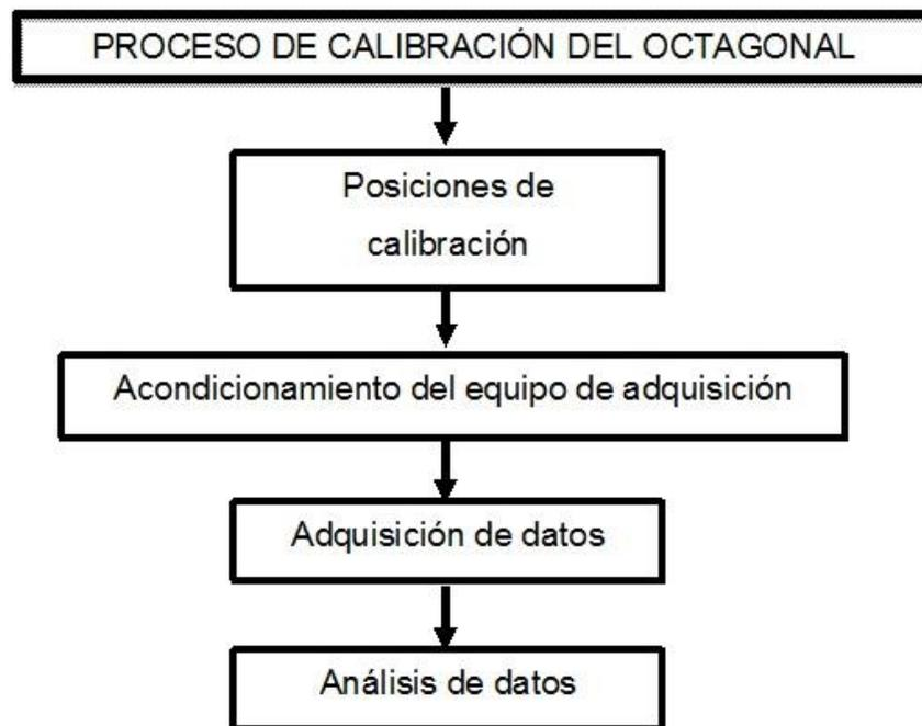
**Fig.3.1. Diagrama del proceso de calibración del octagonal extendido**
