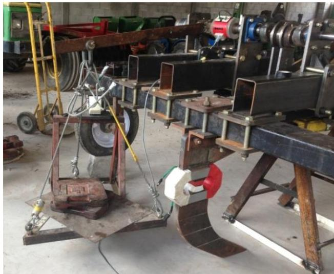
**Fig.3.3. Brazo de palanca con dos distancias (0.85 y 0.65m) acoplado al torquímetro**
