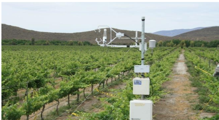
Figura 1. Sensores de un sistema Eddy sobre una plantación de vid para medir los flujos de calor, vapor de agua y bióxido de carbono entre el dosel de la plantación y la atmosfera circundante.
