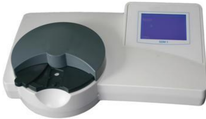
Figura. 10. Fotómetro o Spermacue para hacer el conteo de espermatozoides en el volumen de los sementales.
